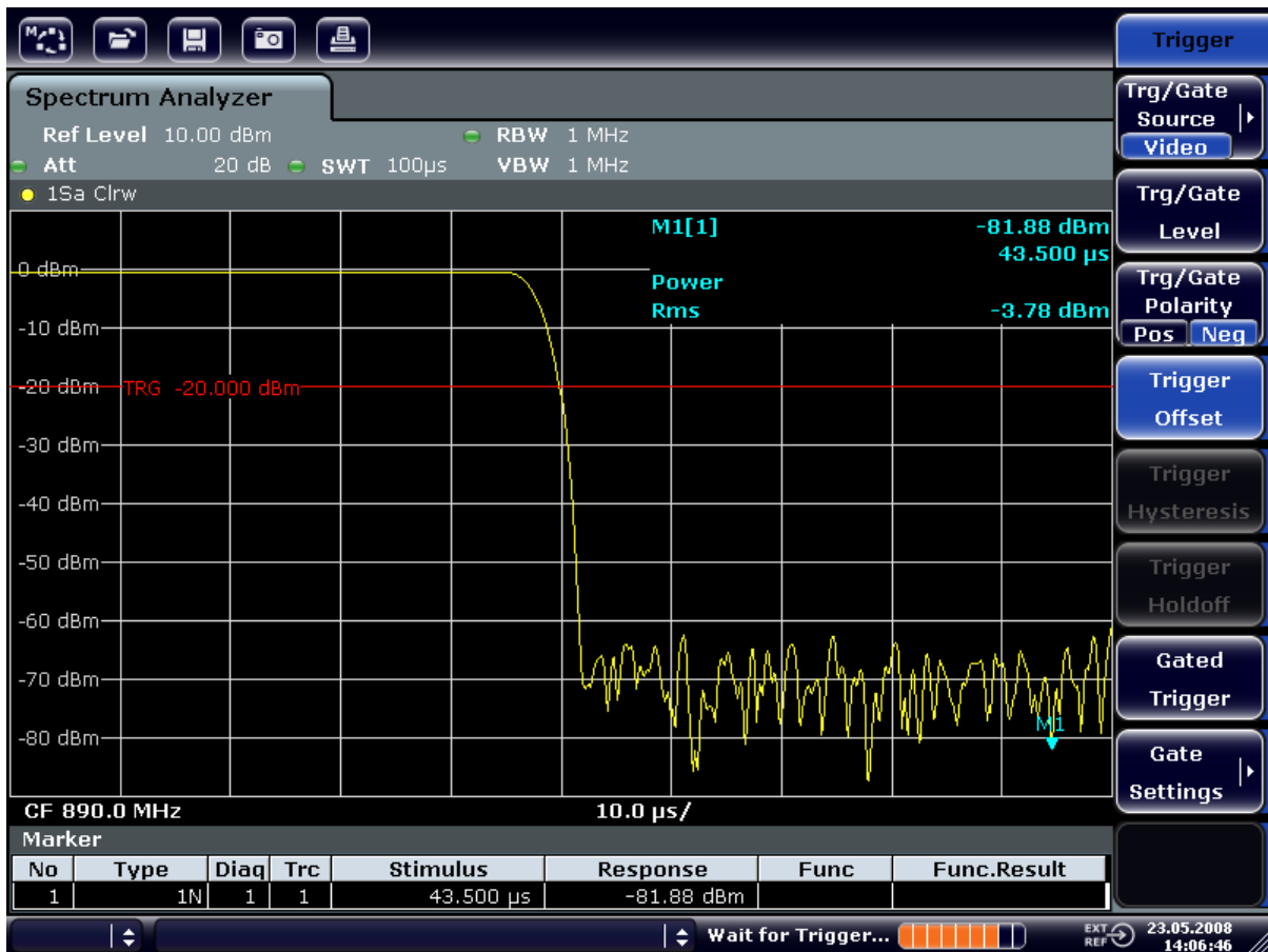
図 6-10: 時間分解能を上げて GSM パーストの立ち下がリエッジを表示
